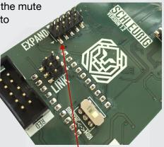
EXPAND CONNECTOR PIN1
